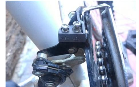
**Simplificándolo mucho:** si la cadena se sale hacia el interior de la bici se aprieta el tornillo L y si se sale hacia el exterior se aprieta el H.
